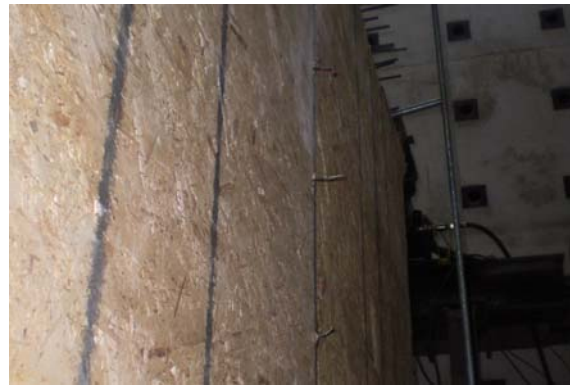
(d) Nail pull out at the middle of panel
