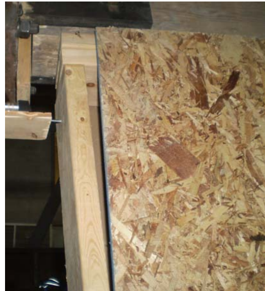
(d) Shear deformation of the wall at the OSB side
