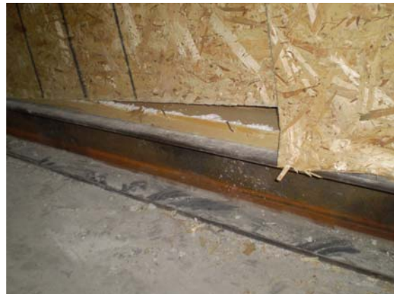
(d) Rotation of OSB sheet and nail bending
