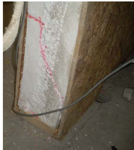
(d) Foam-OSB debonding and OSB crushing
