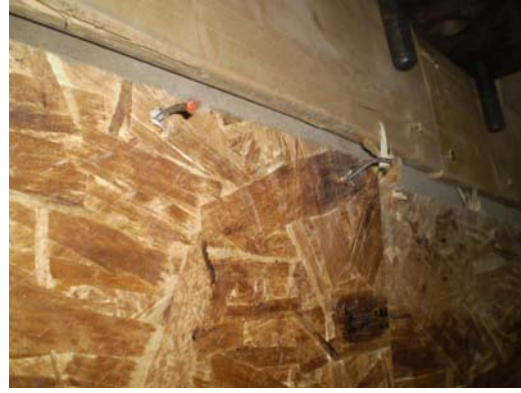
(d) Nail pull out at the middle of panel
