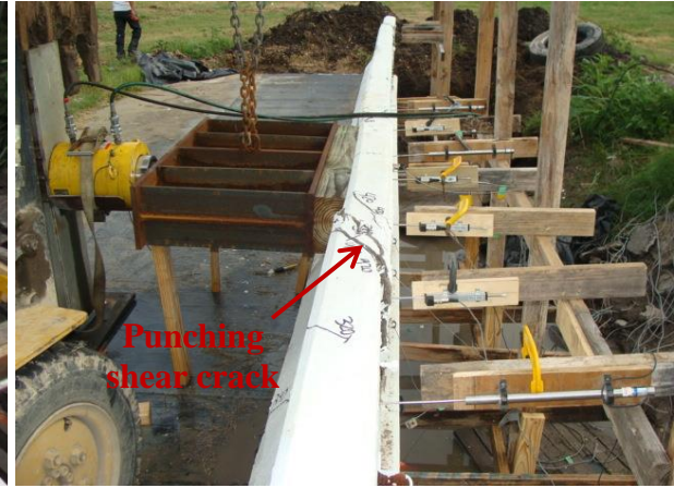
(d) Punching shear through wall thickness
