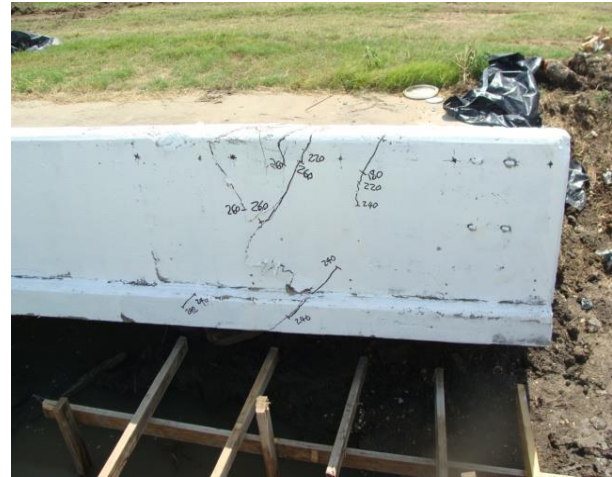
(d) Crack pattern at back face
